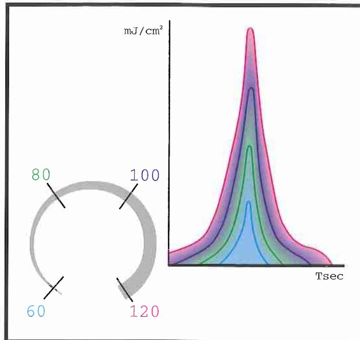
Regolazione continua della potenza specifica delle lampade da 60 a 120 W/cm.
