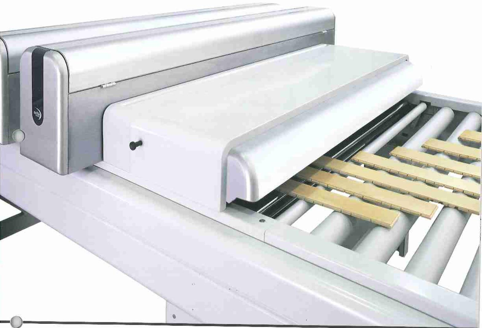
Il nuovo forno UV 2000 è stato progettato in versione monolampada per migliorare le qualità e la potenza di emissione delle lampade, avere maggiori possibilità di regolazione e prestazioni costanti nel tempo.
