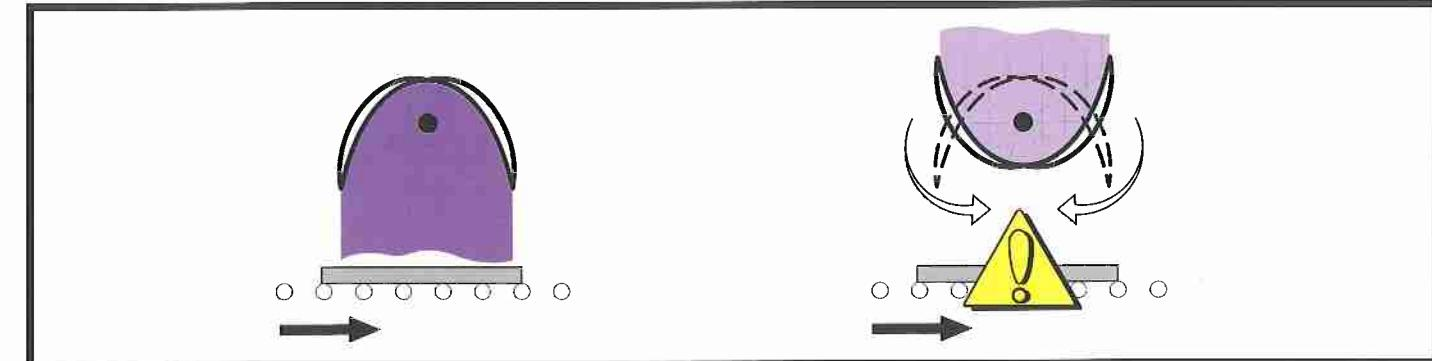
L'innovativo sistema di rotazione della plafoniera con occultamento della luce UV, migliora la sicurezza in caso di arresto della linea.
