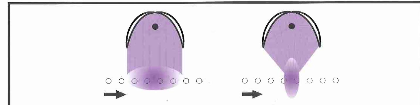
Possibilità di avere parabole a riflessione concentrata o diffusa in funzione del tipo di vernice UV utilizzata (acrilica o poliestere).
